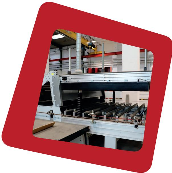
Die Anlage ist für das Kaschieren mit Laminaten bis zu einer maximalen Breite von 2400mm ausgelegt.
